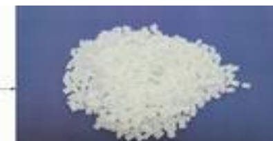
生分解性インフレーションフィルム用樹脂
