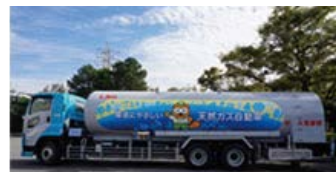
LNG tanker truck fueled by CNG
